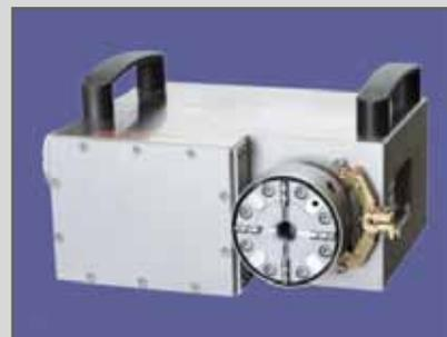
Hochgeschwindigkeits-Rotier-spindeln ermöglichen völlig neue Produktionsverfahren auf Sodick Drahterodiermaschinen. Rotationssymmetrische Teile können mit hoher Oberflächengüte erosiv geschliffen bzw. gedreht werden. Schwierige oder aufwendige Konturen, für die bisher mehrere Bearbeitungsprozesse benötigt wurden, können auf Drahterodiermaschinen von Sodick durch erosives Drehen kostengünstig hergestellt werden.
