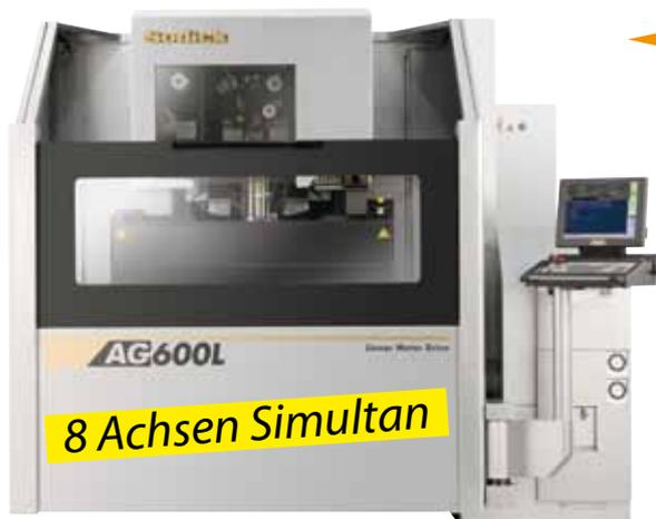
Sodicks neue AG-Baureihe von Drahterodiermaschinen verfügt über Linearmotoren auf 4 Achsen um höchste Präzision und Zuverlässigkeit zu gewährleisten.
