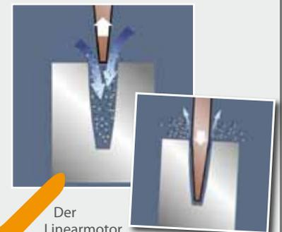
Der Linearmotor erzeugt einen ultraschnellen Pump-effekt bei der Bearbeitung und entfernt so effizient Rückstände wie Partikel, Gas oder Kohlenstoff zwischen Elektrode und Werkstück. Darüber hinaus kann die Bearbeitung ganz ohne Spülung erfolgen.
